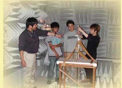
電波の反射しない部屋 でのアンテナの実験
